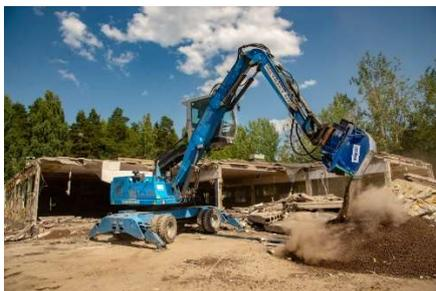
Die HRVB Hydraulische Recycling-Vakuummschaufel ermöglicht ein schnelles und einfaches Sortieren verschiedenster Abfälle und Materialien. Hier wird die Schaufel zum Sammeln von Blähton (LECA) verwendet. Durch die Vorsortierung werden Abfallbehandlungsgebühren gespart.
